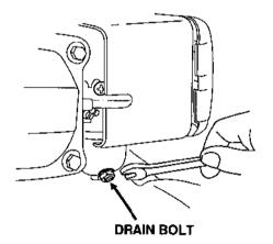
3. Reinstall the drain bolt.
