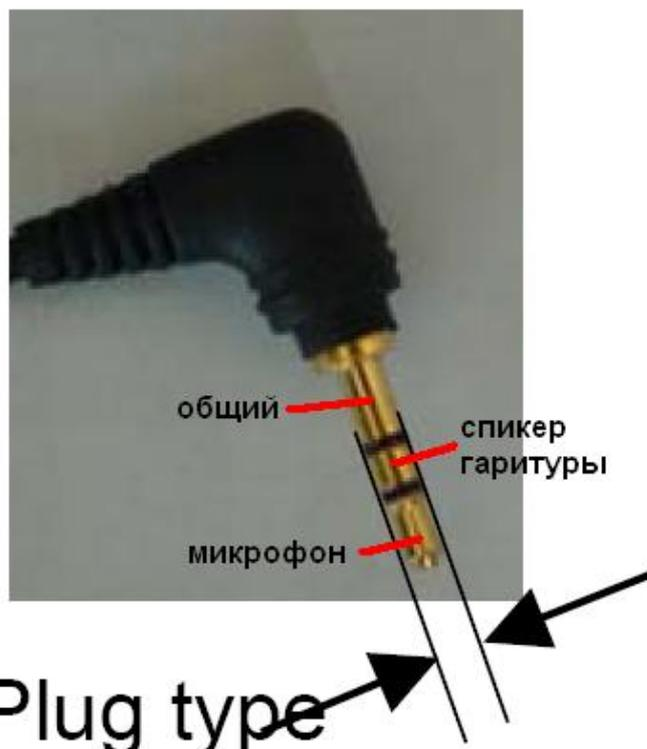
На моем экземпляре сопротивление между «общим» и «спикером гарнитуры» равно 33Ом, сопротивление «микрофон» относительно «общего» 2,4 кОм в одну сторону и 1,4кОм в другую- но эти значения могут отличаться.
