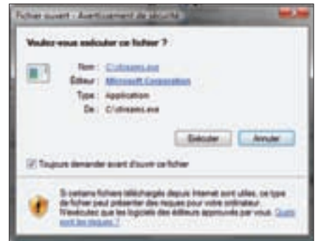
Figure 4. Alerte de sécurité due à la présence d'un ADS :Zone.Identifier.
